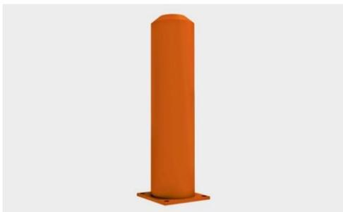
Столбики отбойные предназначены для предотвращения повреждений угловых стоек ворот при наезде автопогрузчика, устанавливаются перед ними внутри помещения. Диаметр отбойного столбика — от 100 до 159 мм.
