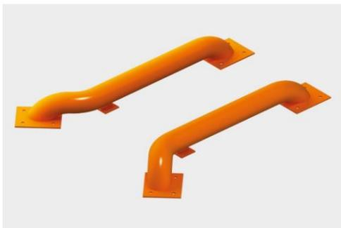
Направляющие для колес предназначены для обеспечения быстрой и точной парковки автомобиля в доке, а также предотвращения повреждения герметизаторов и стен здания. Направляющие разработаны таким образом, чтобы свести к минимуму возможный контакт с ободом колеса автомобиля. Они представляют собой стальные трубы диаметром 159 мм с отводами для крепления. Направляющие устанавливаются на площадке перед доком двумя способами — на анкерных болтах и с помощью бетонирования.
