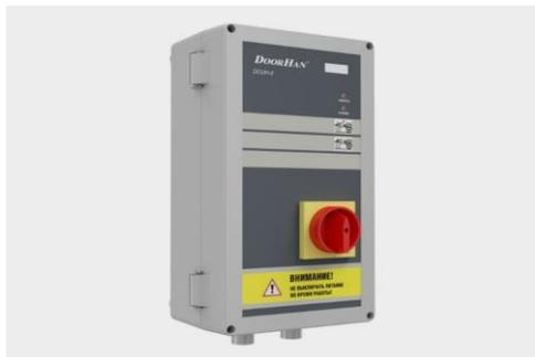
Блок управления DCUH-2 — с расширенными функциями. Питание 380 В 3 фазы. Управление платформой осуществляется по удержанию кнопки. Автоматический возврат в парковочное положение — по однократному нажатию кнопки АУТО. Блокировка платформы при закрытых воротах. Возможность подключения внешнего/внутреннего светофора. Освещение платформы. Индикатор необходимости технического обслуживания. Цифровой дисплей.
