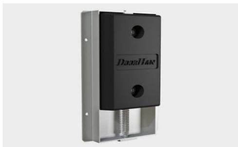
Артикул «BRM600x364x110». Построен на базе бампера 450 x 250 x 100 мм. Бампер резиновый 600 x 364 x 110 мм (внешние размеры) подвижный. Следует движениям грузового автомобиля вверх и вниз при погрузке/разгрузке. Обладает значительно большей износостойкостью благодаря подвижности. Установочные размеры смотрите в разделе «Чертежи».
