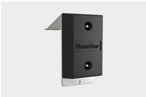
Артикул «BRC510x250x330». Построен на базе бампера 450 x 250 x 100 мм. Бампер резиновый 510 x 250 x 330 мм (внешние размеры) консольного типа. Обеспечивает безопасный подъезд грузового автомобиля к погрузочному месту и предотвращает повреждение стен здания. Используется в случае, когда высота кузова автомобиля может быть больше высоты пандуса. Установочные размеры смотрите в разделе «Чертежи».
