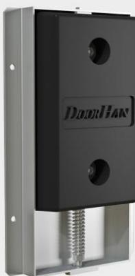
Артикул «BRM600x364x110». Построен на базе бампера 450 x 250 x 100 мм. Бампер резиновый 600 x 364 x 110 мм (внешние размеры) подвижный. Следует движениям грузового автомобиля вверх и вниз при погрузке/разгрузке. Обладает значительно большей износостойкостью благодаря подвижности. Возможно использовать только с платформами с выдвижной аппарелью длиной 1 000 мм. Установочные размеры смотрите в разделе «Чертежи».
