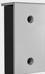
Артикул «BRSP(10)460x250x160». Построен на базе бампера 450 x 250 x 100 мм. Бампер 460 x 250 x 160 мм (внешние размеры) со стальной рабочей накладкой толщиной 10 мм. Состоит из амортизирующего по всей поверхности наполнителя (резинового бампера 450 x 250 x 100 мм), закрытого прочной внешней стальной пластиной. Установочные размеры смотрите в разделе «Чертежи».
