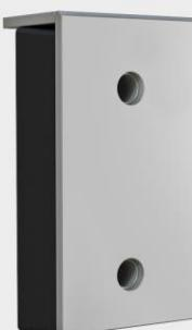
Артикул «BRSP(16)465x250x165». Построен на базе бампера 450 x 250 x 100 мм. Бампер 465 x 250 x 165 мм (внешние размеры) со стальной рабочей накладкой толщиной 16 мм. Состоит из амортизирующего по всей поверхности наполнителя (резинового бампера 450 x 250 x 100 мм), закрытого прочной внешней стальной пластиной. Установочные размеры смотрите в разделе «Чертежи».
