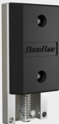
Артикул «BRM610x250x175». Построен на базе бампера 450 x 250 x 100 мм. Бампер резиновый 610 x 250 x 175 мм (внешние размеры) подвижный. Следует движениям грузового автомобиля вверх и вниз при погрузке/разгрузке. Обладает значительно большей износостойкостью благодаря подвижности.
