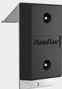
Артикул «BRC510x250x330». Построен на базе бампера 450 x 250 x 100 мм. Бампер резиновый 510 x 250 x 330 мм (внешние размеры) консольного типа. Обеспечивает безопасный подъезд грузового автомобиля к погрузочному месту и предотвращает повреждение стен здания. Используется в случае, когда высота кузова автомобиля может быть больше высоты пандуса. Установочные размеры смотрите в разделе «Чертежи».
