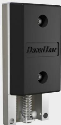
Артикул «BRM610x250x175». Построен на базе бампера 450 x 250 x 100 мм. Бампер резиновый 610 x 250 x 175 мм (внешние размеры) подвижный. Следует движениям грузового автомобиля вверх и вниз при погрузке/разгрузке. Обладает значительно большей износостойкостью благодаря подвижности. Установочные размеры смотрите в разделе «Чертежи».
