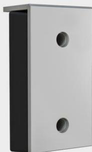
Артикул «BRSP(16)465x250x165». Построен на базе бампера 450 x 250 x 100 мм. Бампер 465 x 250 x 165 мм (внешние размеры) со стальной рабочей накладкой толщиной 16 мм. Состоит из амортизирующего по всей поверхности наполнителя (резинового бампера 450 x 250 x 100 мм), закрытого прочной внешней стальной пластиной. Установочные размеры смотрите в разделе «Чертежи».
