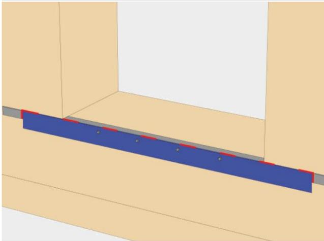
Исполнение для выступа пандуса здания 0 мм (пандус здания заподлицо со стеной здания)
