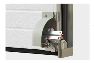
Устройство защиты от обрыва троса устанавливается в качестве нижнего кронштейна на полотно ворот. В случае обрыва троса механизм срабатывает и не дает полотну ворот упасть.
